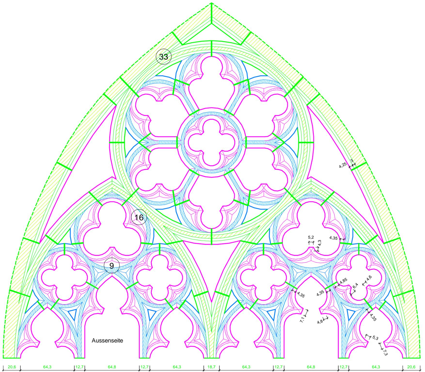
Übergang Maßwerk zu Rippen nach dem Versetzen noch anpassen
